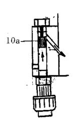
Messwasserstrom sinkt der Schaltkörper nach unten, die Dosierung wird gestoppt. Anzeige am Display "Wassermangel". Beim Schaltpunkt ist die Chlormessung nur geringfügig - etwa 5-10 % - verfälscht.
