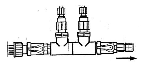
Das Desinfektionsmittel (Chlorlösung) und der pH-Senker (Säure) werden durch federbelastete Kugelventile (23) in das Dosierrohr eingespeist. Die beim Dosieren von Chlorlösung gefürchtete Blockierung des Dosierventils durch Kalkablagerungen wird dadurch weitgehend vermieden, dass die dosierte Säure über die Chlordosieröffnung strömt. Das Impfventil für Chlor ist gelb gekennzeichnet, das für Säure rot.
