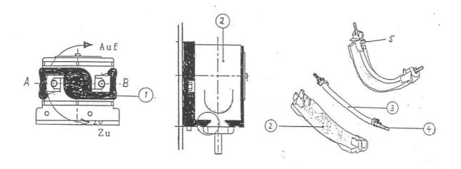
1 - Riegel 2 - Laufband 3 - Dosierschlauch 4 - Schlauchtülle 5 - Schlauchklemme
