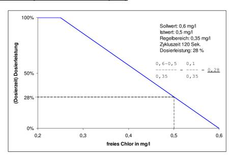
Im Beispiel läuft die Chlordosierpumpe alle 2 Minuten 34 Sekunden lang bei Leistungseinstellung 100% und 17 Sekunden bei 50%.
